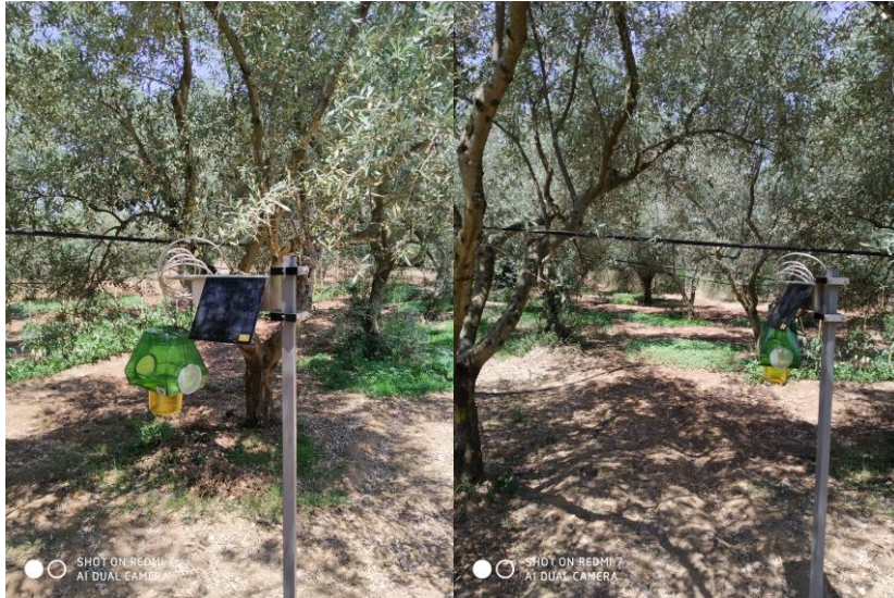
Εικόνα 1. Ηλεκτρονική παγίδα iMETOS iSCOUT® Fruit Fly για συλλήψεις ατόμων δάκου
